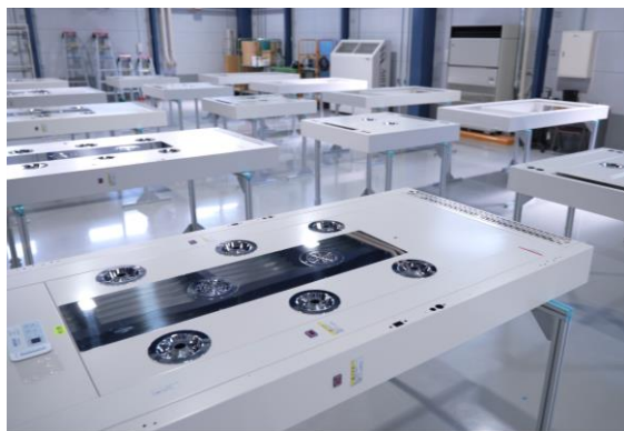
エアーシャワー組立作業
