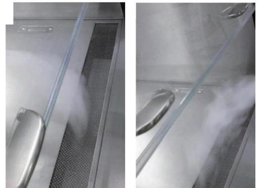
最適な気流により確実なエアバリアを形成。
