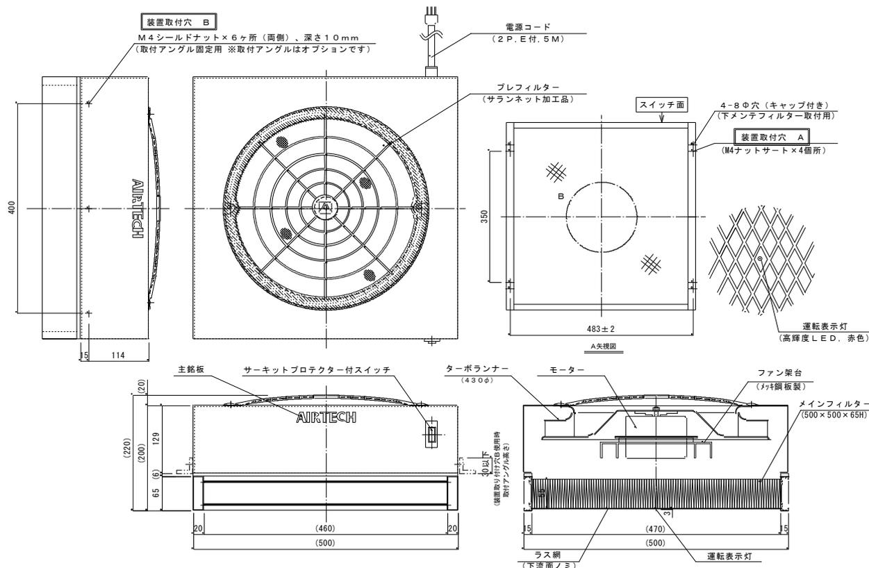
※ 装置への取付は、メンテナンスの方向に応じ、装置取付穴 A 又は B を御使用下さい。装置取付穴 B を御使用の場合は、取付用アングルが別途必要となります。
